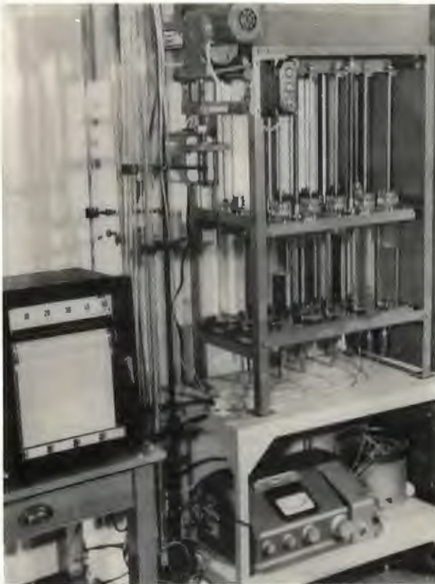
Bild 1: Apparatur zur vollautomatischen säulenchromatographischen Bestimmung freier Aminosäuren.
